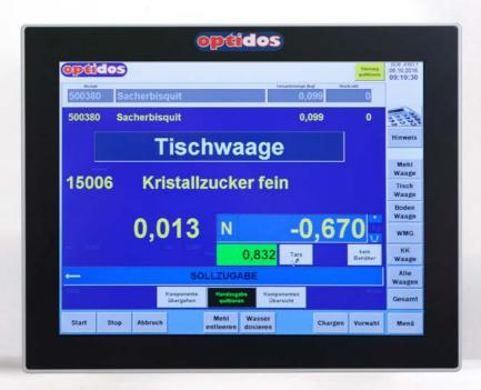
optidos Profi, ausgestattet mit einem vollgrafischen Touchscreen, bietet eine einfache und übersichtliche Menüführung, mit der neben Silos und Mehlwaagen alle wichtigen Stationen in der Teigmacherei gesteuert werden können. Bereits nach
