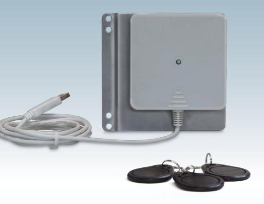
Die Eingabe der Benutzerdaten an den einzelnen Geräten entfällt und vereinfacht das Arbeiten. Die eingesetzten Chips sind mit bestehenden Zeiterfassungssystemen kombinierbar, so dass jeder Mitarbeiter nur einen Chip mit sich führen muss. Darüber hinaus lassen sich Knetschalen per RFID einzelnen Rezepten zuordnen und die Teigruhe steuern und überwachen.
